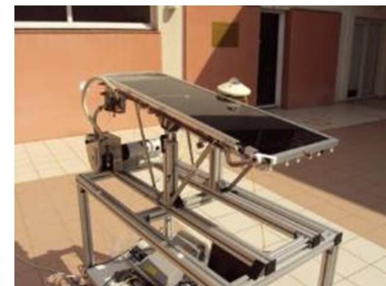
Photobioréacteur solaire « AlgoFilm » (ANR Biosolis)
