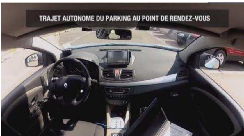
Véhicule électrique Fluence Z.E. Avec option valet-parking développée par Renault dans le projet PAMU (financement partiel par le CG Yvelines, 2011-2013)
